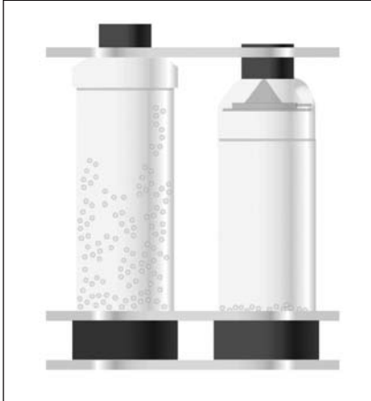
FIGURE 4 : Dans une simulation du comportement des particules d'aérosol à l'aide de billes de polystyrène, les billes sont attirées par la charge électrostatique vers les parois de la CRV non conductrice (gauche), tandis qu'aucune bille ne s'accroche aux parois de la CRV faite de matériaux dissipateurs de charge (droite)
